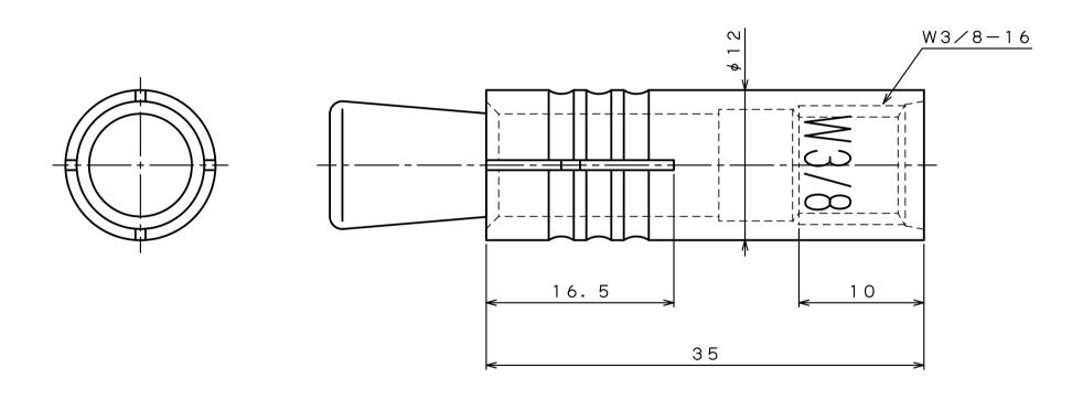
表面処理:電気亜鉛めっき黄色クロメート処理
